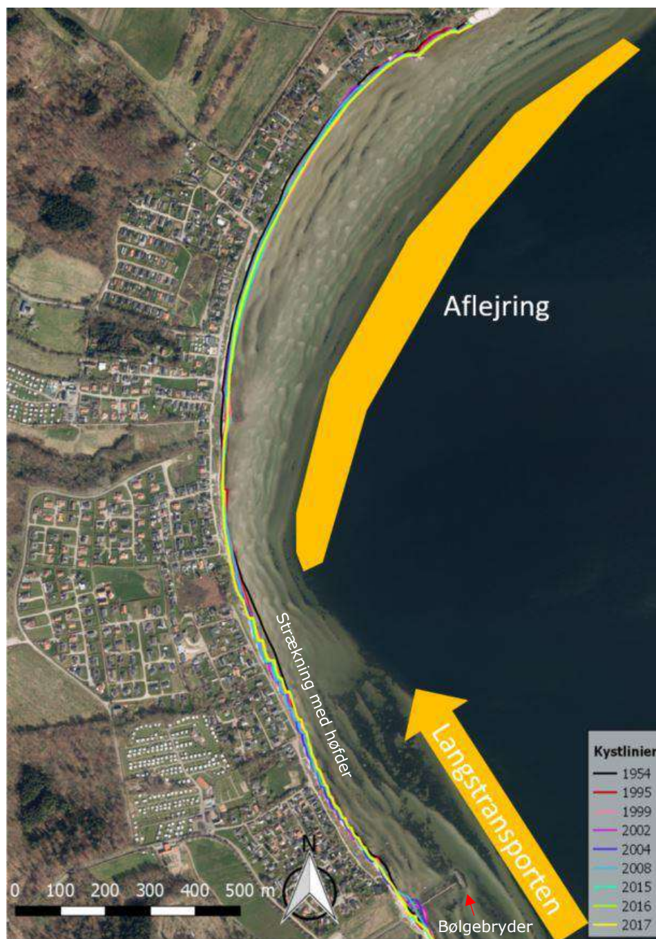
Figur 6.1: Digitaliserede kystlinjer mellem 1954 og 2017 med erosion i det sydlige område og aflejring i det centrale og nordlige område. Erosionsområdet er markeret med transportpil mod nord, da sandet fragtes i denne retning. Aflejningsområdet i den centrale og nordlige del er kendetegnet ved, at der sker aflejring på stranden, ved fremrykning af kystlinjen og ved de mange revler.
