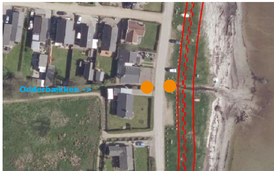
Figur 5.8: Udløb af Oddebækken, Dige (vist med røde linjer) samt alternative placeringsmuligheder for traktorpumpe (vist med orange cirkler).
