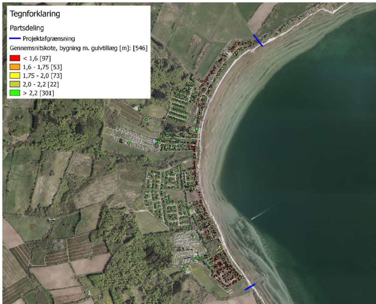
Figur 9.2: Kort over beregnet sokkelkote/gulvkote for huse i området
