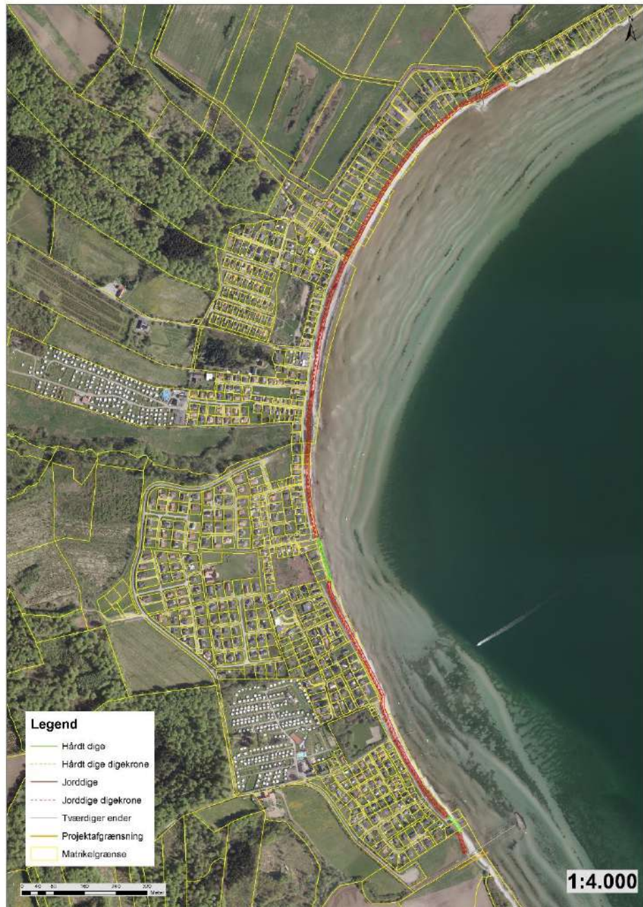
Figur 5.6: Foreslået tracé for kystdige samt digeudbredelse ved topkote i +2,2 m DVR90. Se Bilag 1 for større kortformat.
