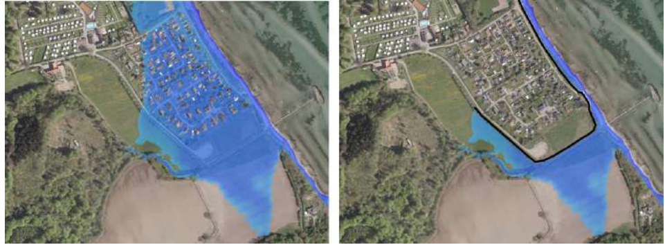
Figur 5.2: Oversvømmet landbrugsområde ved havvandsstand på +2,2 DVR90 i situationen før etablering af dige i kote +2,2 m DVR90 (venstre) og efter etablering (højre, dige markeret med sort). Se Bilag 5 for større kortudsnit.
