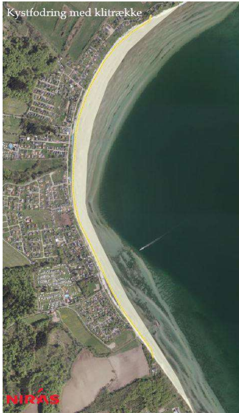
Figur 6.2: Kysten efter strandfodring samt klitrække med markering af hjelme på klittoppen med samme højde som det foreslåede jorddige.
